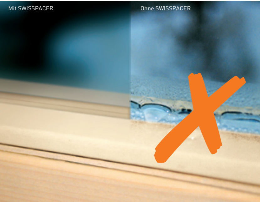
Tauwasser an Fenstern entsteht bei niedrigen Temperaturen am Glasrand. Mit SWISSPACER oder SWISSPACER V wird die Gefahr der Tauwasserbildung gegenüber der Verwendung von Aluminiumabstandhaltern deutlich reduziert. Beispiel Holzfenster: Bei Verwendung von Aluminiumabstandhaltern tritt unter gleichen Temperaturrandbedingungen ab -1 °C Außentemperatur Tauwasser auf. Bei Verwendung von SWISSPACER V erst ab -10 °C Außentemperatur.
