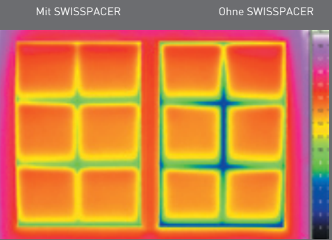
Mit SWISSPACER V erreichen Sie bei gleichen Temperaturrandbedingungen auch mit Sprossen bis zu 5,3 °C höhere Temperaturen am Glasrand.
